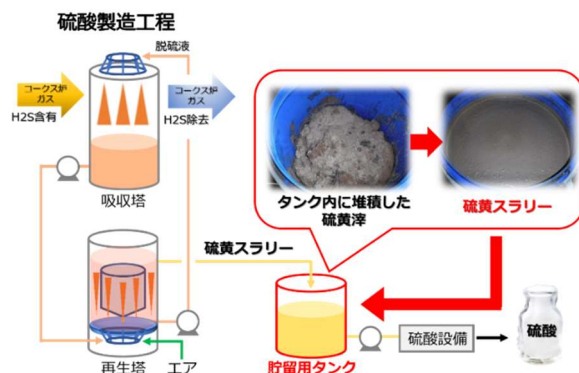
図4. 硫酸製造工程における副生物回収フロー
