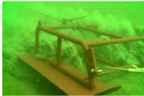
海底耕うん(漁船で桁を曳いて海底を耕している) を行っている海底の様子(JF兵庫漁連提供)
