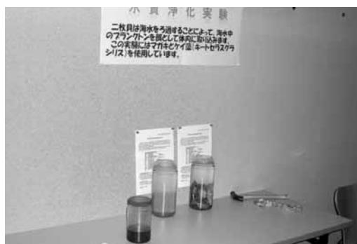
図11-1 マガキによる水質浄化実験図
