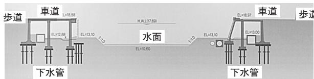
図-4 下水道システム等の復元断面図（例）
