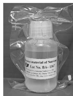
図-3 出来上がった参考物質（100mL）開封後ポリビンから多項目同時分析装置のサンプルカップに移すのみで使用可能
