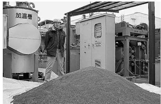
写真-2 実証設備で回収した人工リン資源
