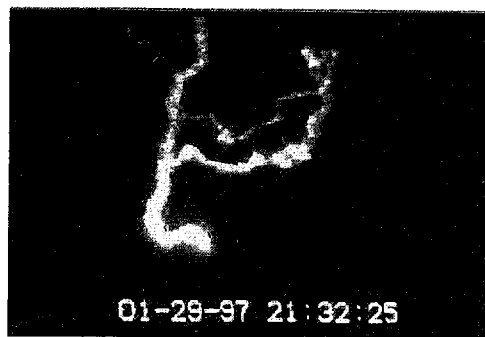
図—4 レーザーにより誘発された上向き放電 (H9.1.29)
