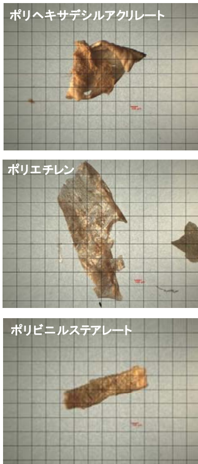
図5 大阪湾底泥中のマイクロプラスチック
