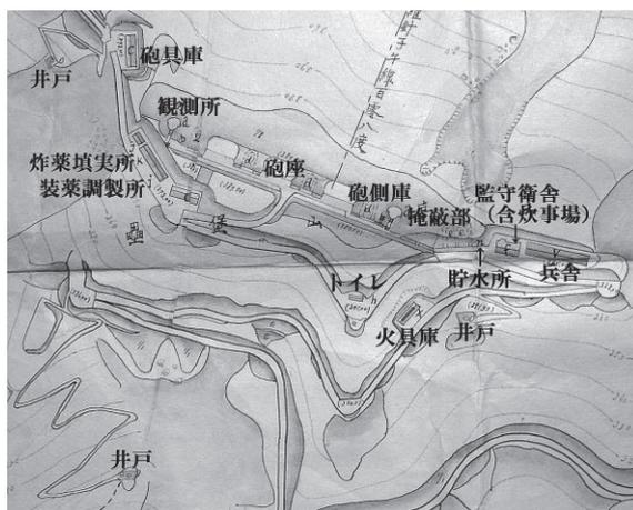
図-1 広島湾要塞・三高山北堡塁（防衛大学校総合情報図書館蔵に加筆）標高385mに位置する二八榴6門で厳島海峡入口を制圧する。現在は公園として整備されている。
