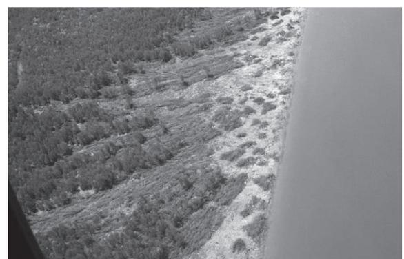
図-2 津波の後のマングローブ林（引き波によって地盤がえぐられた状況）
